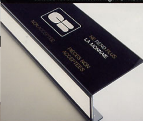
Vorder Teil einem Automat aus PC 8mm, gebogen, Siebdruck und Kratzfest Beschichtet
